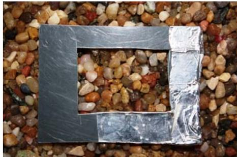
Figure 3.23. Gabarit de mesure (visuelle) de la granulométrie de surface.
