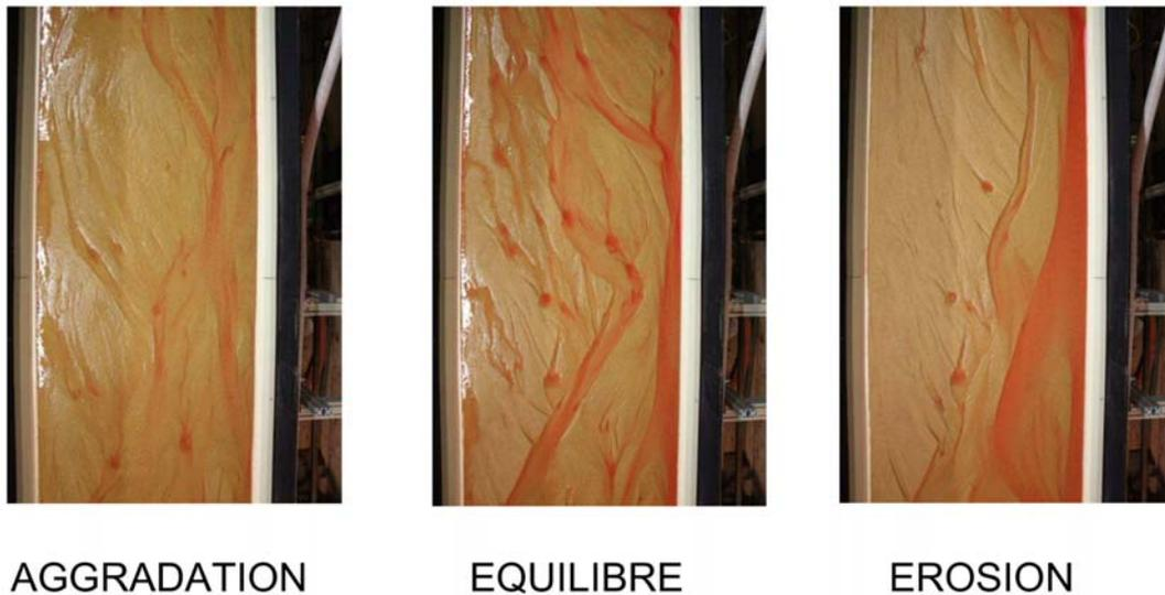
Figure 3.34. Lits en tresses produits avec des sédiments uniformes.
